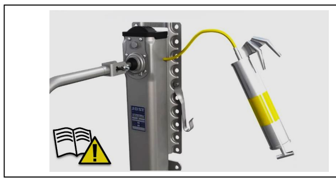
مرحله دوم: استفاده از سیلندر مخصوص جهت روغن کاری (تقریباً ۲۰۰ گرم)
