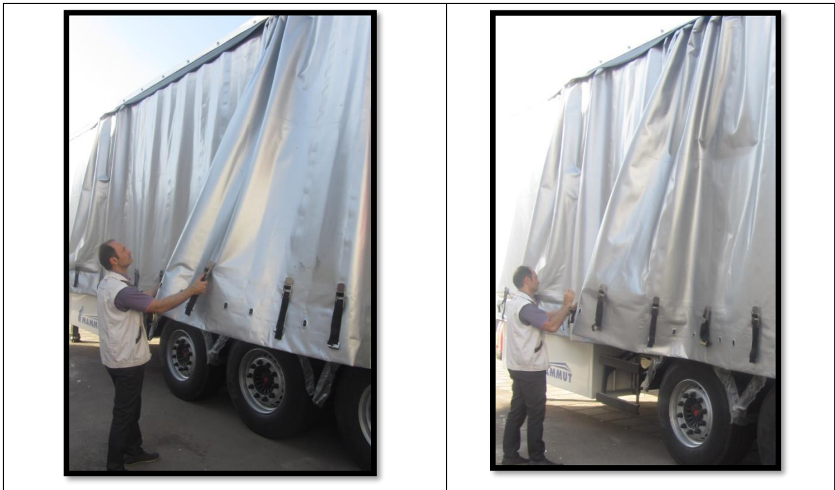
نحوه باز و بسته شدن جک روی ستون‌های عقب و جلو جهت افزایش ارتفاع سقف تریلر:
