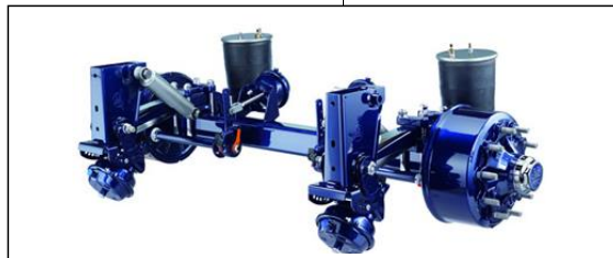
محور BPW کاسه‌ای - مقطع میل محور (مربع)
